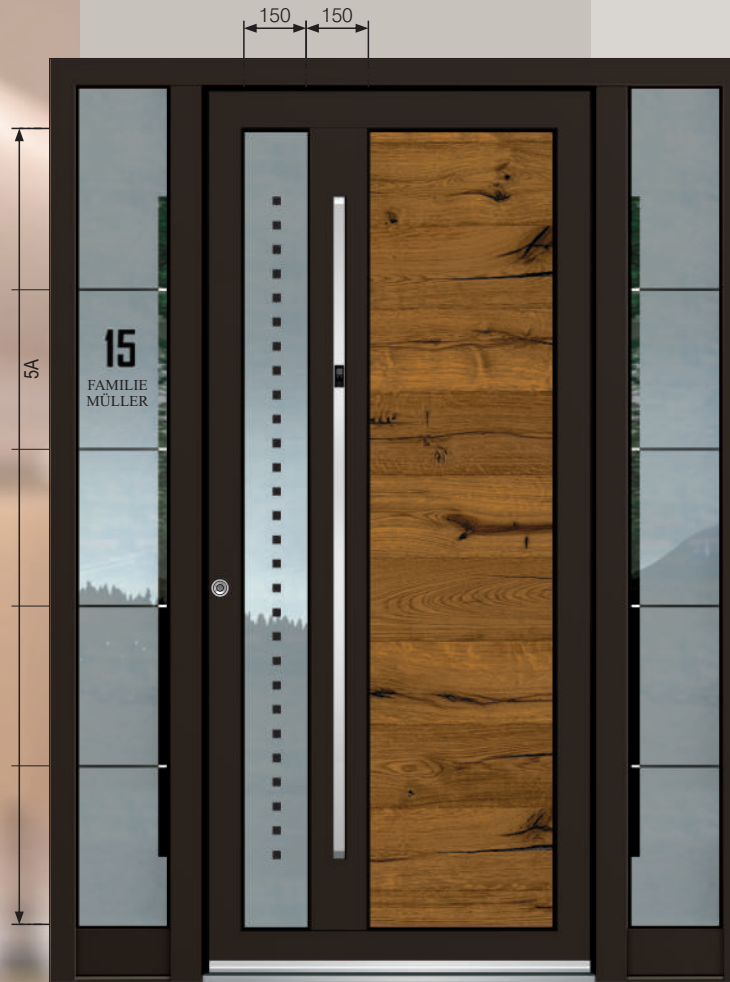
ASS 1758 Sprosse 150 mm Zubehör Glasmotiv MS 6801 Griff außen ZAE 715 Farbe RAL 8022 FS matt Paneel außen DD 416 - Split Eiche Dunkel Seitenteil ST 01 / WG / 400 Glasmotiv MS 6801/S + Hausnummer HFG
